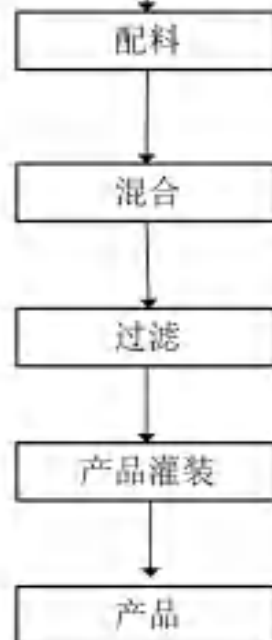
图 2-4 迷迭香提取物/混合生育酚浓缩物/食品香味添加剂/复配食品添加剂工艺流程图
